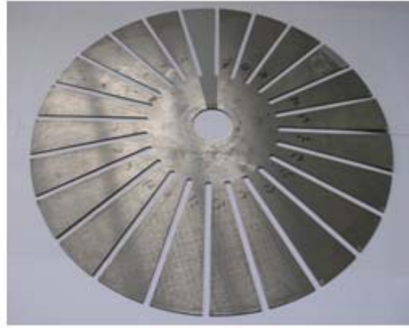
Fig. 4-3. Flat Blisk (before bending)
